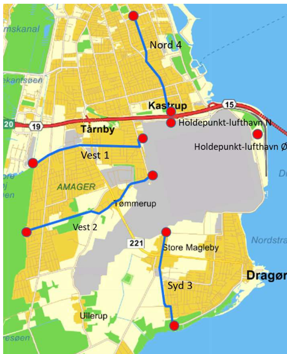
Figur 2.1. Skitse af måleruten, som gennemkørtes 43 gange i løbet af måleperioden. Lufthavnsområdet er markeret med gråt. De røde punkter angiver de 15-minutters holdepunkter, hvor bilen holder stille. De blå streger angiver transekterne, hvor ændringerne i luftkoncentrationerne af ultrafine partikler og kvælstofdioxid måles, mens målebilen kører hen mod eller væk fra selve lufthavnsområdet. Der er holdepunkter for hver ende af de fire transekter og to ekstra holdepunkter. Det ene af disse er placeret mellem lufthavnen og motorvejen i forlængelse af det nordlige transekt (Holdepunkt-lufthavn N). Det andet er placeret øst for lufthavnen (Holdepunkt-lufthavn Ø). Baggrundskort: Krak.
